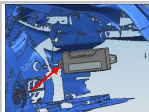
4.2 装 ECU：把 ECU 安放在尾箱右侧此空旷处（圆圈），用 1 颗 M6 螺母固定好防止松动；
