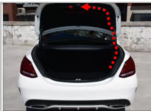
3.3 信号线布置到上门锁,右撑杆电机线沿着后踏板底部把线布置到右侧连接右撑杆
