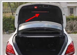
3.1 拆卸上门锁盖板,然后把线束如虚线穿到上门锁盖板
