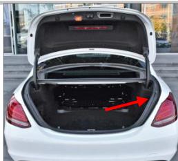
2.1 把右边内侧装饰件拆下，并妥善保管好，后续还原安装；(箭头)
