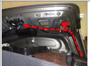
3.6 布线:把2扎布线束(接开关、接门锁信号)延伸到尾箱上门锁扣处,延伸线用胶布或扎带固定好;(虚线)
