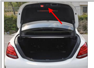
3.7 把信号线引到上门锁扣位置,用与连接原车信号线
