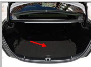
3.10 看到原车尾箱内部电瓶,我司正极线接原车电瓶正极;正极取电需如图 3.14 正确安装,其他位置有锁车休眠风险
