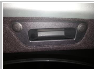
4.4 安装开关按钮：拆下原车此装饰件，用我司配的开关底座配合开关按钮安装好后，再复原回去；
