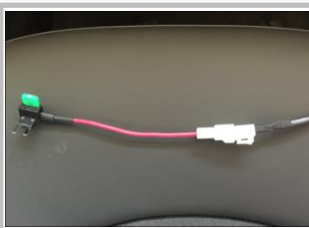
3.11 如图示意接正极取电器,用我司正极插头插进原车保险盒内
