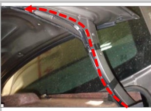
3.5 布线 把2扎布线束 接开关、接门锁信号、)从尾箱右侧沿着摇臂延伸到上门锁(虚线)
