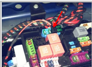
3.12 接正极电源:用我司配的正极取电器如图正确插入原车保险丝内;切勿反插可能导致无法通电
