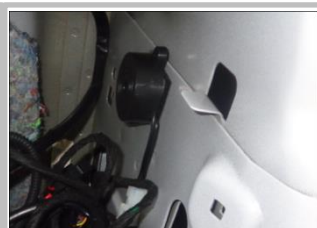
4.6 安装蜂鸣器：与 ECU 接头对接，并把蜂鸣器装在装饰板内空旷处；（箭头）
