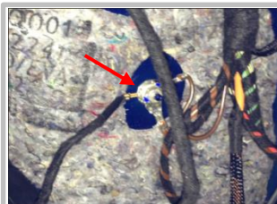
3.13 接负极：在右侧装饰板内找到螺丝，把我们的负极线搭上，松动螺母不用拆下，卡紧后再还原拧紧螺母
