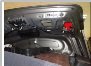
3.4 如图尾箱盖板已取下,盖板妥善保管
