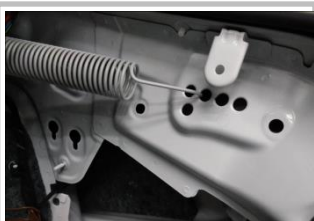
2.2 拆原车气弹簧 把原车右边气弹簧拆卸； 注意防止尾门掉下；
