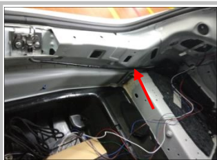
1.7 用扎带把箭头位置的拉线固定好，防止拉线与盖板、钣金摩擦；
