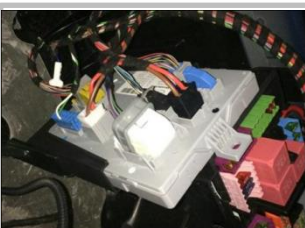
3.14 接 CAN 信号线：在尾箱右侧找到线束（箭头），然后找到我们要接的信号线
